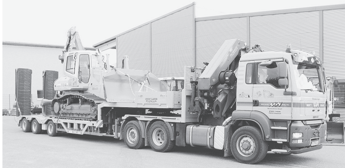
Ein teleskopierbares Michael-Welte-Transportspezialfahrzeug mit Hydrodrive sowie hydraulischen Lenkachsen. Der Kran leistet 36 Metertonnen.
