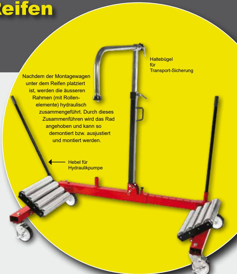
Nachdem der Montagewagen unter dem Reifen platziert ist, werden die äusseren Rahmen (mit Rollenelemente) hydraulisch zusammengeführt. Durch dieses Zusammenführen wird das Rad angehoben und kann so demontiert bzw. ausjustiert und montiert werden.
